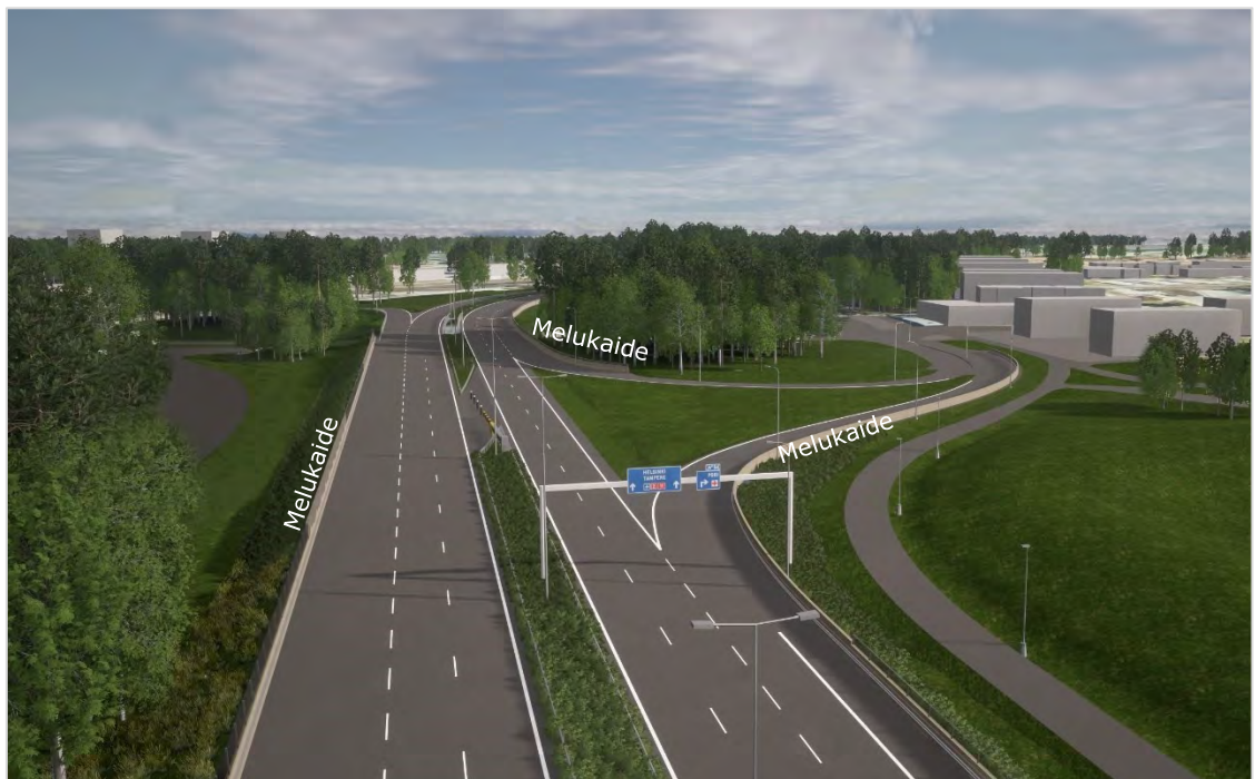
Kuva 9-22. Tiilimäen liittymän aluetta lännen suunnasta vaihtoehdossa VE 1. Kuvassa erottuvat valtatie ja liittymien melukaiderakenteet. Kuva viitteellinen.
